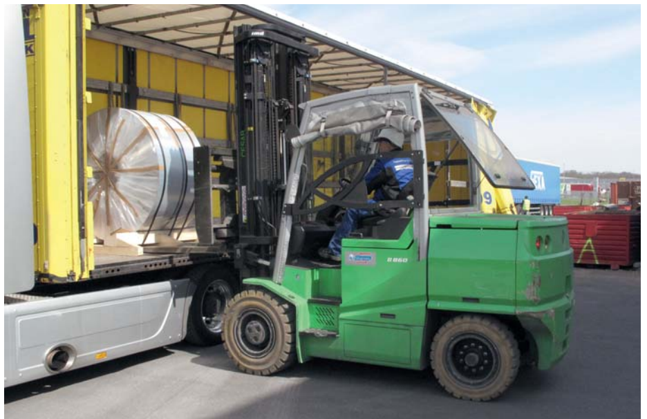
Beladung des Lkw mit fertig verpackten Coils mit einem Schwerlast-E-Stapler der Reihe B 860 mit 8,5 t Tragfähigkeit
