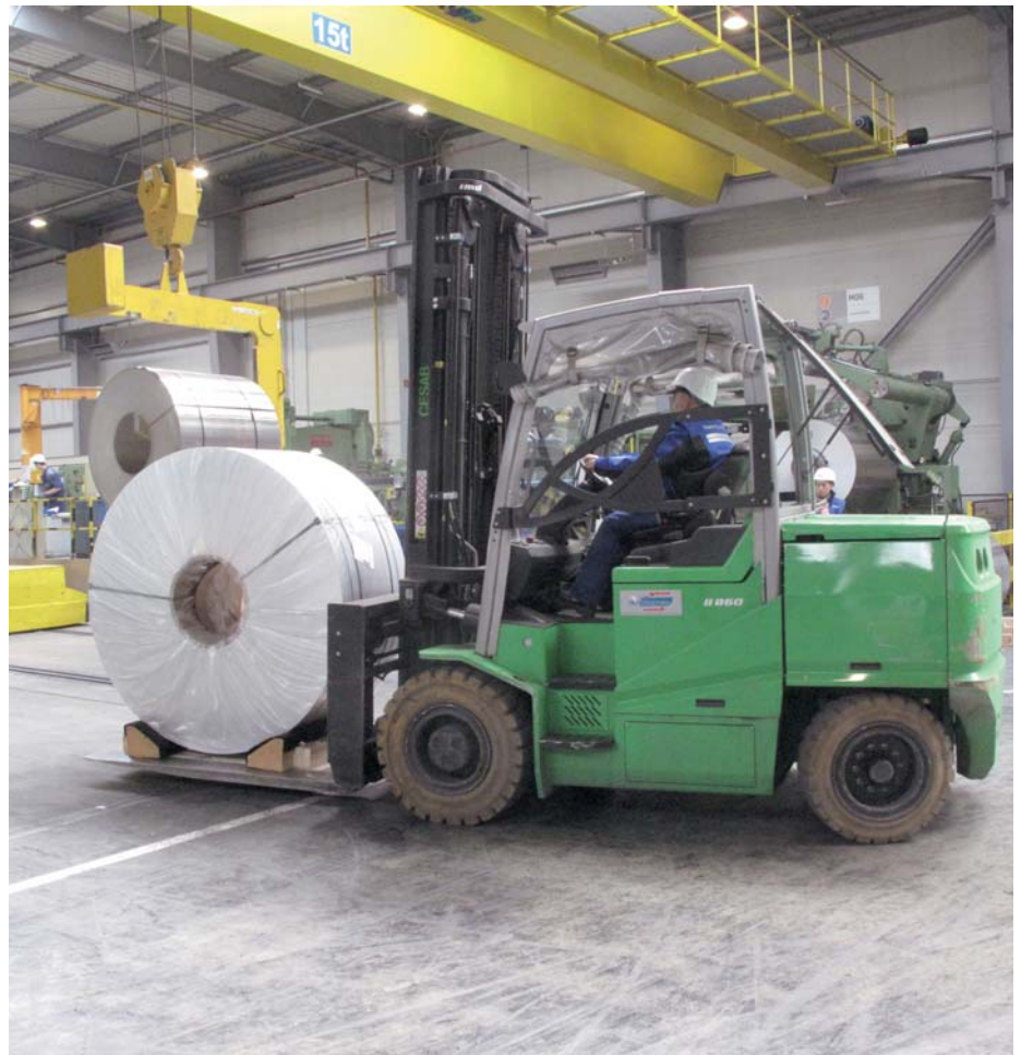
Transportfahrt durch die Werkshalle: Alle Cesab-Stapler sind mit Hallenbodenschonender „nicht-kreidender“ Bereifung ausgestattet
