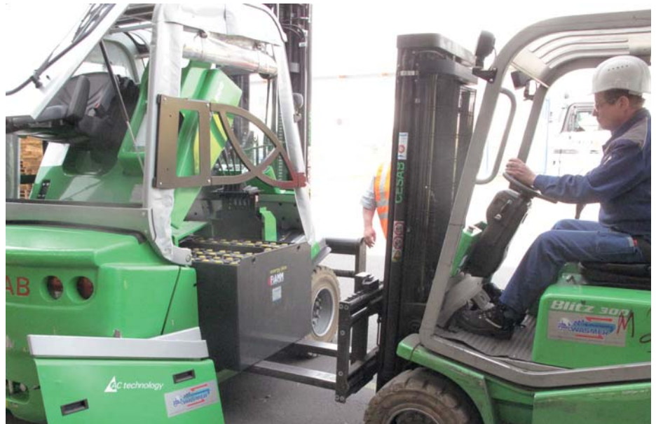
Ideal für den Dreischichtbetrieb ist ein ebenso schneller wie sicherer und schonender Batteriewechsel. Die Batterie wird mit den Gabelzinken unterfahren, leicht angehoben und aus dem Fach herausgezogen
